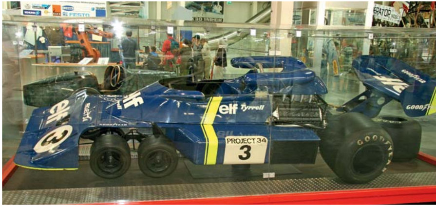
Tyrrell P34, den eneste 6-hjulede bilen Formel-1 har sett så langt. Tyrrells plan var at 4 små forhjul skulle gi mindre aerodynamisk løft i forhold til 2 større hjul da P34 ble introdusert i 1976, men det ble med 1 seier av totalt 30 løp.
