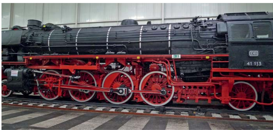
Serie 41 damplokomotiv, opprinnelig konstruert av BMAG i 1934, og produsert for DRB mellom 1937 og 1941. Med sine 123 tonn (ifølge plakaten) og 2+8+2 hjul er denne jernhesten et mektig skue.
