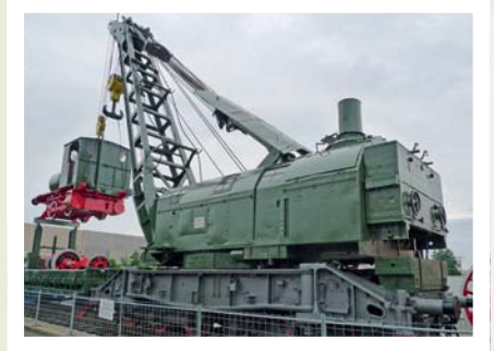
Dampkran, bygd på understellet til en skinnegående kanon fra andre verdenskrig. Kranen ble brukt til oppryddingsarbeid like etter krigen.
