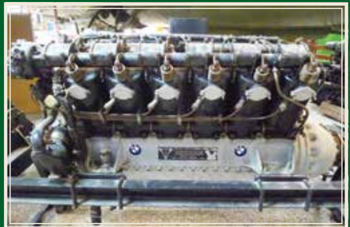
BMW type VI, V12 flymotor med 46 liter slagvolum og ca 650 hp, produsert 1926-1938.
