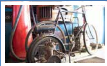
ELDST: En Columbus fra 1898. Motoren påmontert drivhjulet kunne kjøpes som ekstraustyr. Tråsykkelen har kardang.
