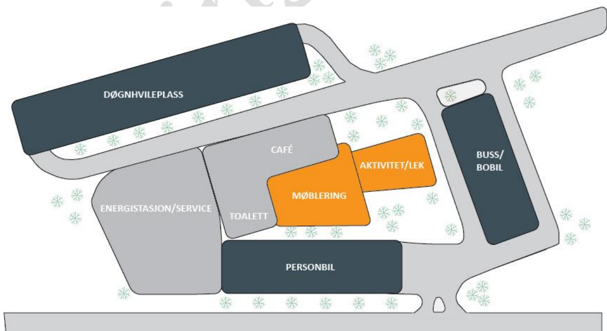
Figur 5: Rasteplass med toalett, servering/handel, møblering og arealer for aktivitet/lek, samt parkering for personbiler, buss og bobiler/campingvogn, døgnhvileplass og energistasjon.
